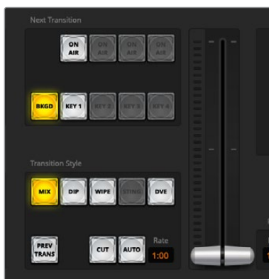
Contrôle des transitions
