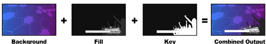
Совмещение фона, заполняющего и вырезающего сигналов при линейном кеинге
