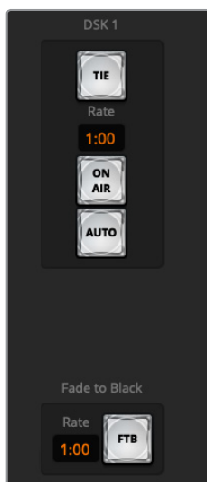
Модуль вторичного кеинга и полное затемнение
