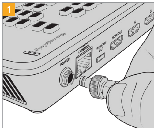
通过所提供线缆将ATEM Mini电源输入与电源相连
