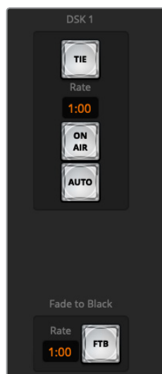
Incrustation en aval et fondu au noir
